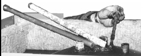
Fig. 1.8.4 (Fra venstre side vises en ny anode / let tæret anode / samt en næsten gennemtæret anode)
