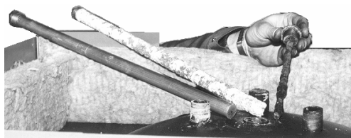
Fig. 1.6.4 (Fra venstre side vises en ny anode / let tæret anode / samt en næsten gennemtæret anode)
