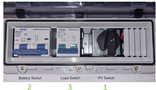
Ill. 6.3 - Afbrydere på KSTAR inverter.
